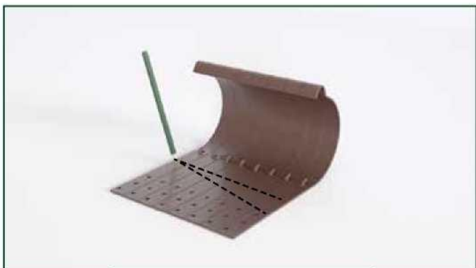
A meghajlítási útvonal kijelölése
