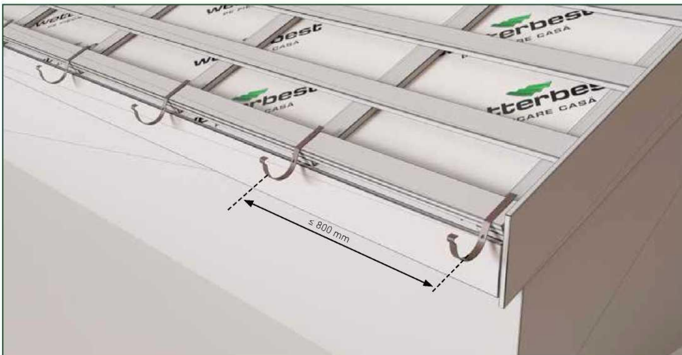
Az ereszcatorna kampók felszerelése
